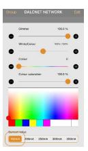
Corrente massima erogabile dal dispositivo per ogni singola uscita: 150mA
